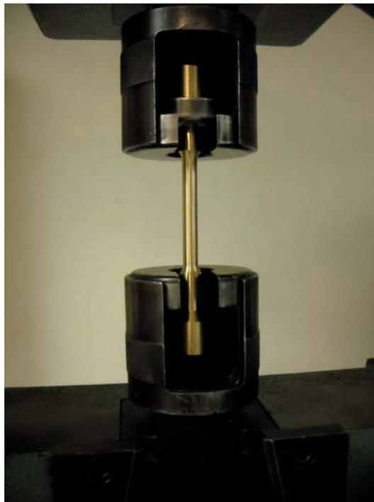
« Fig. 10. Test bar ready for tensile test.
