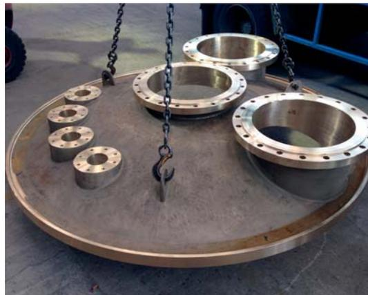
» Fig. 5. Weldless Inoxyda 3P aluminium bronze casting.
